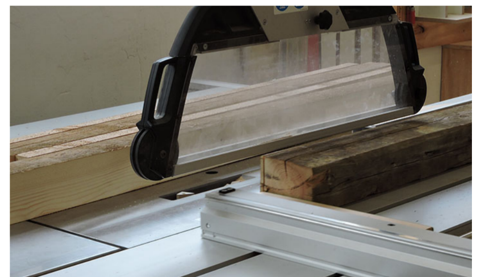
Besäumen von Altholzbalken
