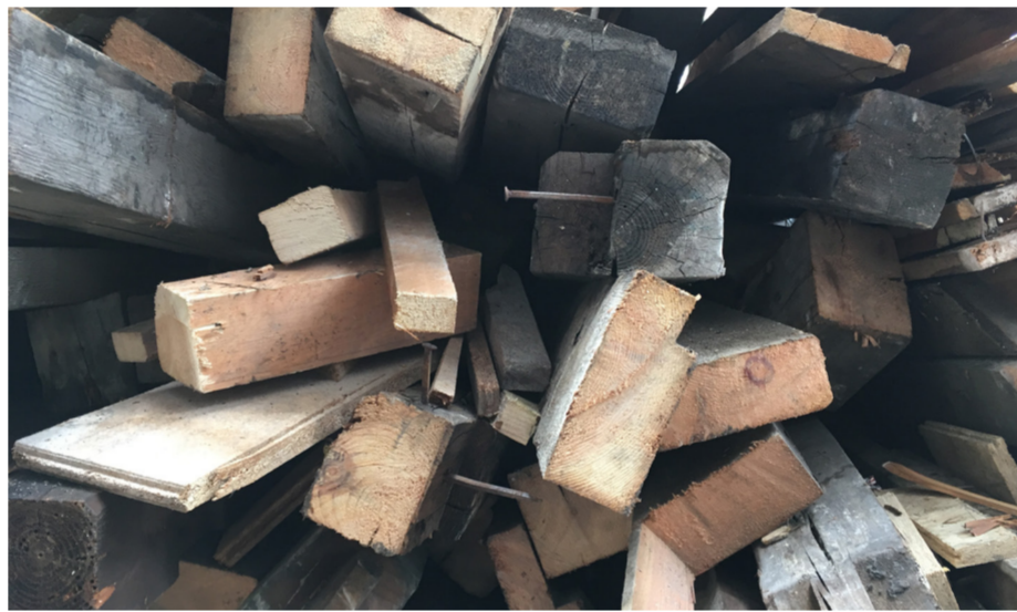
Rückgebautes Altholz aus einem Berliner Dachstuhl
